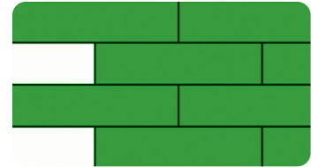
Im Verbundsystem verlegen, die Bahnen dicht an dicht.
